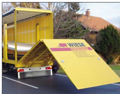
S203 Удължаване на платформата през 10 см
