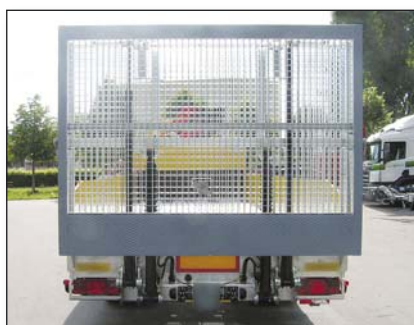
S415.AR2 Мрежеста платформа (за по-малко въздушно съпротивление)
