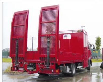
S415.AR Мрежеста платформа (за по-малко въздушно съпротивление) S421 Платформа от 2 части
