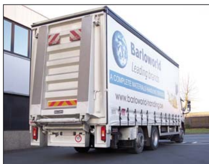
S239.LSU Сгъваема платформа с усилена конструкция на пантите (при такова изискване е необходимо предварително одобрение)
