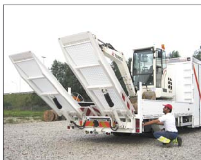
DH-AR 3T - 5T - 9T - 16T Хидравлична рампа с цялостна стоманена платформа
