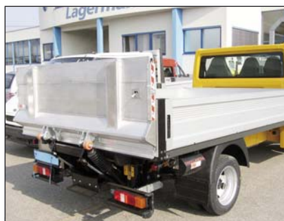
S239 Сгъваема платформа за намаляване на въздушното съпротивление
