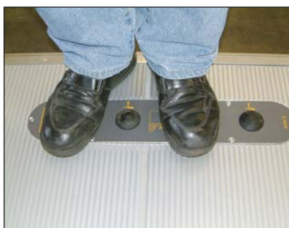
S006 4-бутонно стъпално управление, монтирано на платформата
