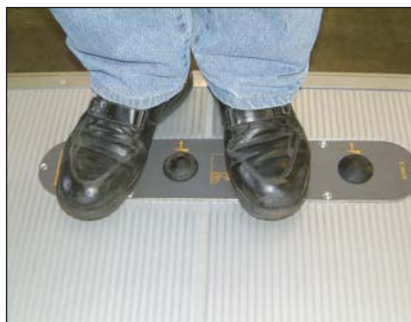
S006 4-бутонно стъпално управление, монтирано на платформата
