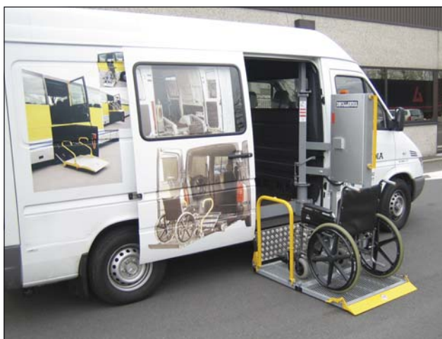
DH-VZH 350 кг - Пътнически колонен лифт
