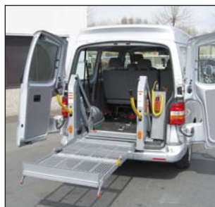
S957 Сгъваема платформа за намаляване на височината на поставяне и за осигуряване на максимална видимост на шофьора назад
