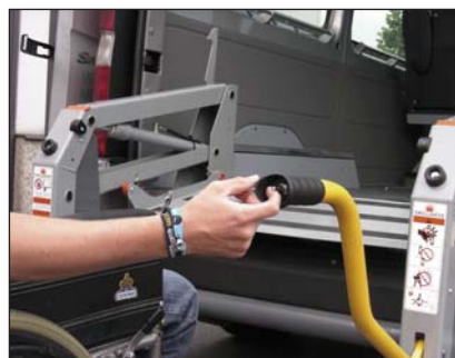
S961 Ключ за функциите нагоре / надолу, монтиран в перилата
