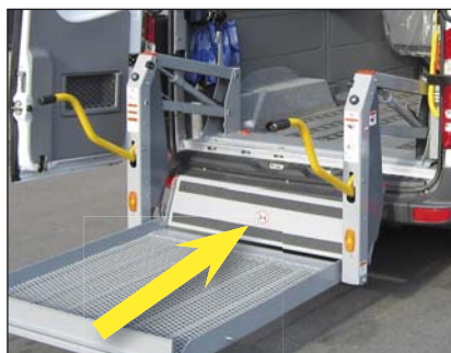
S955 Изравнителен мост, монтиран на платформата
