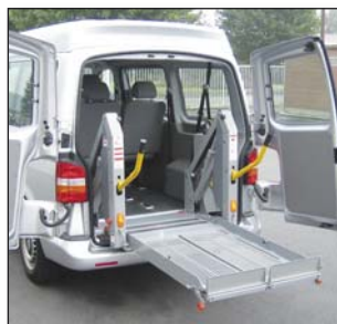
S953 Вертикално сгъваща се платформа за свободен достъп през задните врати
