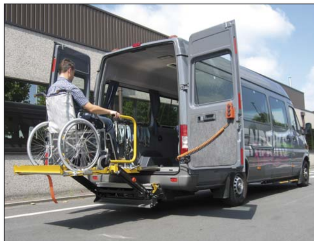
DH-CH 300 кг - Касетен плъзгащ се лифт
