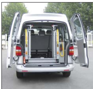
S953 Вертикално сгъваща се платформа за свободен достъп през задните врати
