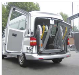
S953 Вертикално сгъваща се платформа за свободен достъп през задните врати
