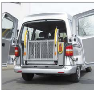
S957 Сгъваема платформа за намаляване на височината на поставяне и за осигуряване на максимална видимост на шофьора назад
