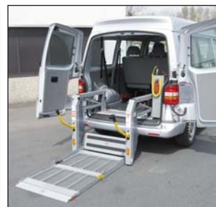
S957 Сгъваема платформа за намаляване на височината на поставяне и за осигуряване на максимална видимост на шофьора назад
