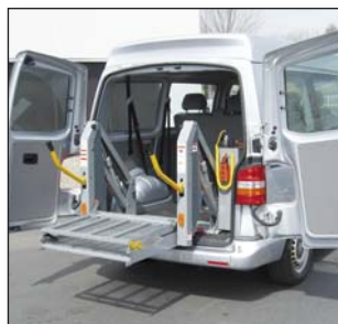
S957 Сгъваема платформа за намаляване на височината на поставяне и за осигуряване на максимална видимост на шофьора назад
