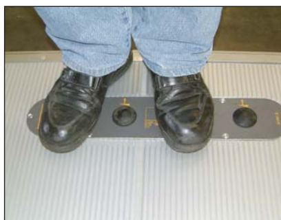
S006 4-бутонно стъпално управление, монтирано на платформата
