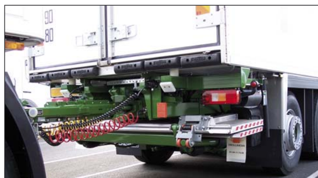
DH-SO 1500-2000 кг Плъзгачи се лифтове със сгъваема платформа за много малък надвес
