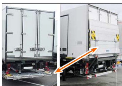
S244 Вертикално прибиране на платформата зад надстройката
