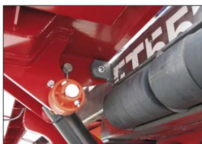
S245 Специално разстояние за монтаж на носещите планки + 10 см
