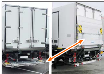
S244 Вертикално прибиране на платформата зад надстройката
