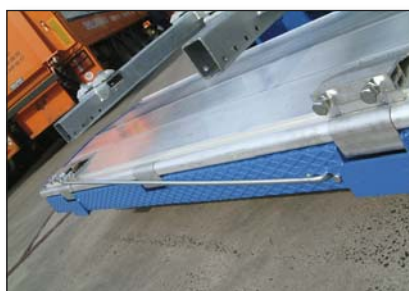
S258 Торзионна пружина на сгъващата се част на платформата
