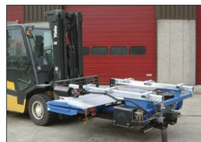
S410 Предварително монтиран лифт на стойка за транспортиране и бърз монтаж
