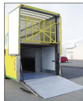
Вътрешен лифт DH-VX + външна хидравлична рампа
