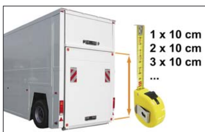
S714 Удължение на височината на платформата през 10 cm
